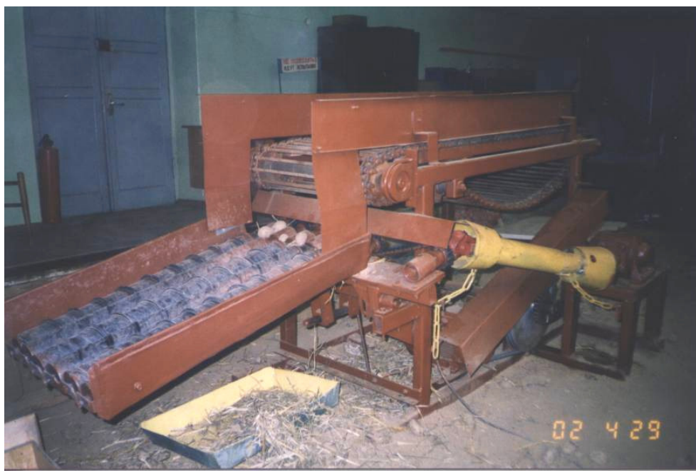
Rys. 1. Stanowisko badawcze z sekcją rolkowego separatora czyszczącego Fig. 1. Test stand with roller cleaning separator section
