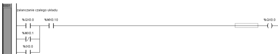
Rys. 4. Układ załączania instalacji podciśnieniowej Fig. 4. Activation system for vacuum installation
