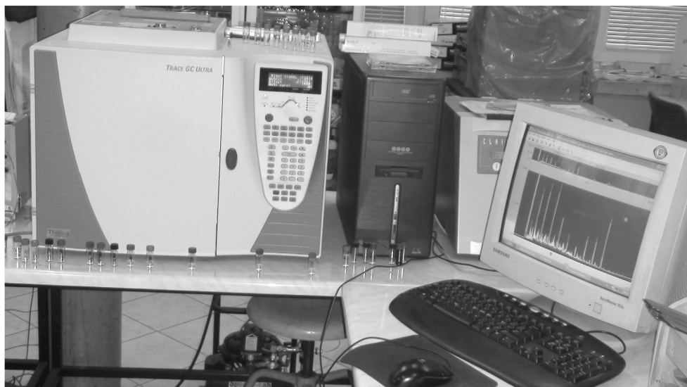
Rys. 1. Stanowisko badawcze wyposażone w wielokanałowy chromatograf gazowy firmy Thermo typ TRACE GC Ultra
