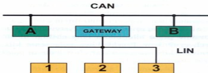
Rys. 2. Sposób podłączenia sieci LIN i CAN [Widerski 2005]
