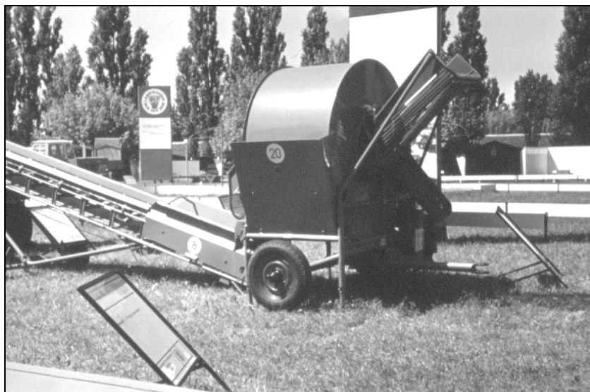
Rys. 4. Wodny separator bulw i kamieni produkcji NRD Fig. 4. Water separator for tubers and stones manufactured in GDR
