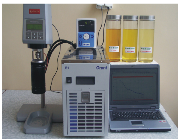
Rys. 2. Stanowisko badawcze wyposażone w reometr oraz wannę termostatyczną Fig. 2. The researchers post was furnished with a reometer and tub thermostats
