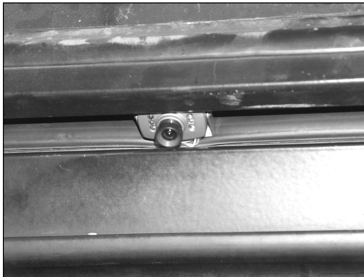
Rys. 3. Kamera zamontowana na ramie tylnej szyby ciągnika Fig. 3. Camera fixed to the frame of tractor rear window
