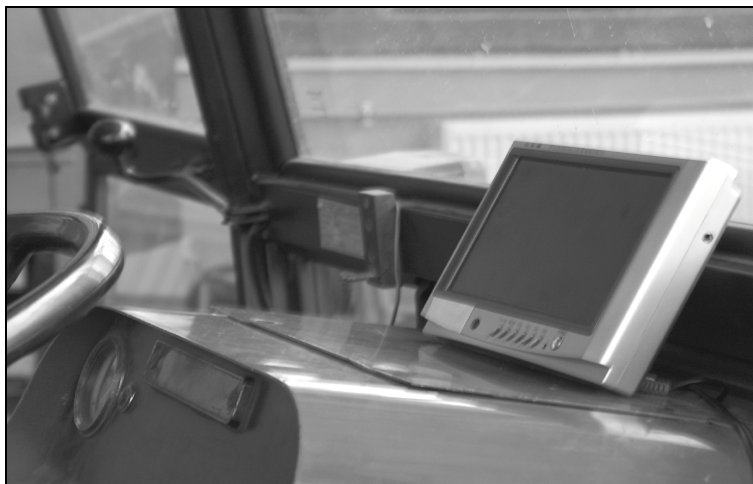
Rys. 4. Widok monitora LCD na desce przyrządów ciągnika
