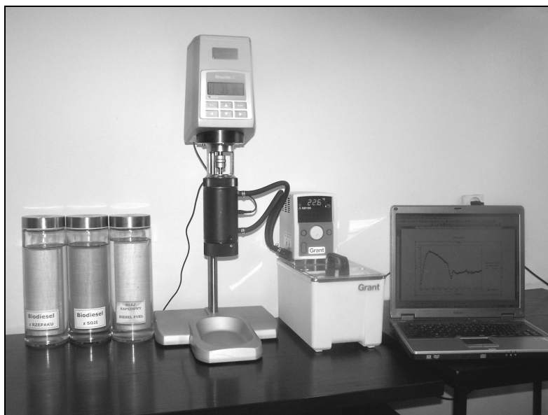
Rys. 1. Stanowisko badawcze wyposażone w reometr oraz wannę termostatyczną Fig. 1. Test stand equipped with rheometer and thermostatic tank
