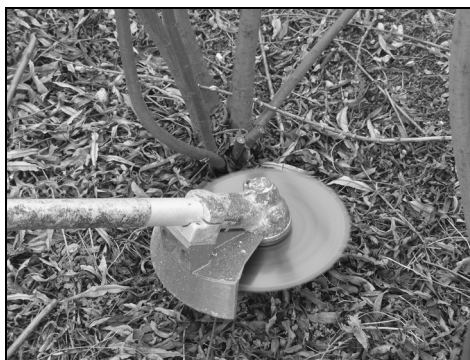
Rys. 1. Kosa spalinowa w czasie ścinania karpy wierzby energetycznej
