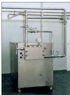
Rys. 1. Fotografia badanego homogenizatora ciśnieniowego CHO-50 Fig. 1. Photograph of the examined CHO-50 pressure homogeniser
