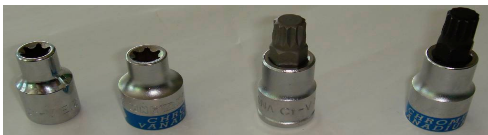
Rys. 4. Badane narzędzia (od lewej): klucz nasadowy E12 - TONA, klucz nasadowy E12 - KINGTONY, klucz trzpieniowy M12 – TONA i klucz trzpieniowy M12 - KINGTONY
