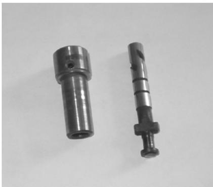
Рисунок 9. Общий вид сменной плунжерной пары с измененным углом наклона винтовой канавки
